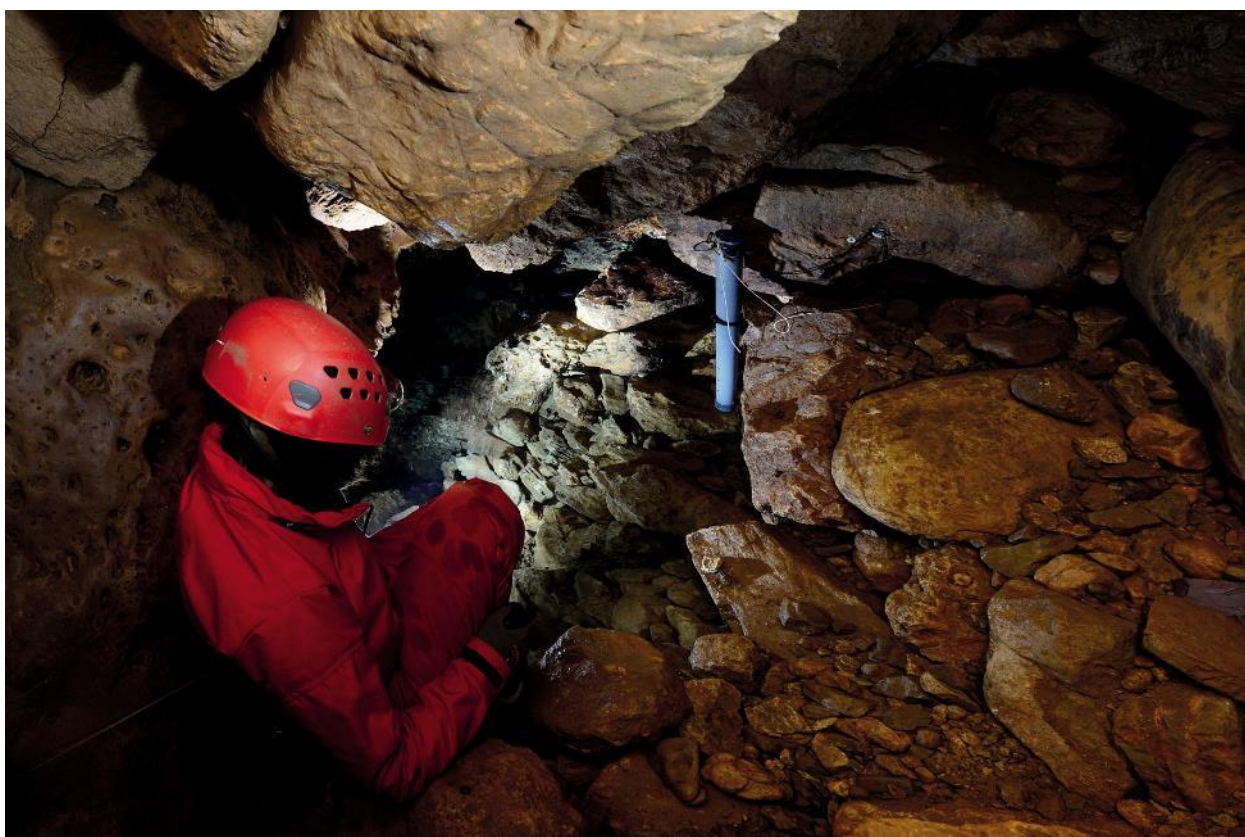
Figure 13 : Tube contenant la sonde de mesure de pression absolue et conductivité/température dans le plan d'eau du siphon en amont de la source de l'Ironselle – Crochet Ph.
