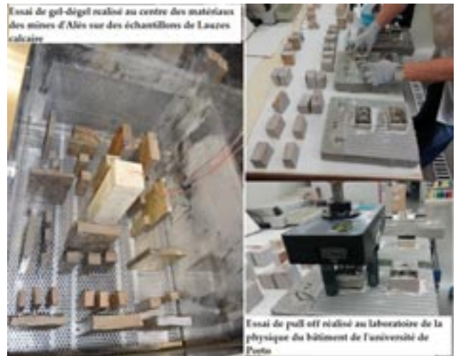
Expérimentations faites sur les lauzes calcaires du massif central réalisées au centre des matériaux des mines d'Alès et au Laboratório de Física das Construções de l'Université de Porto
